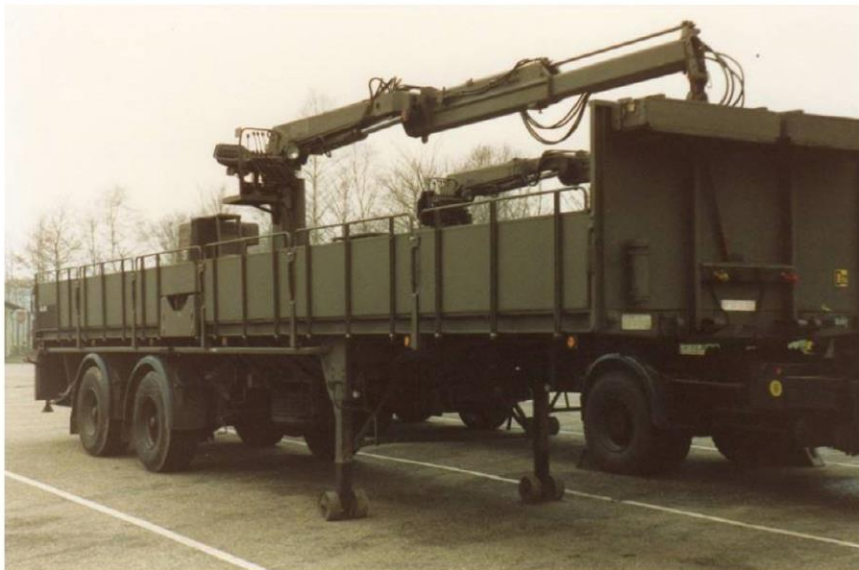
STAU (steenauto)trailer met VALK (verrijdbare autolaadkraan)
