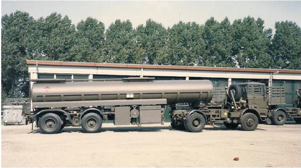
DAF YTV 2300 met LAG brandstoftrailer
