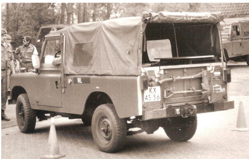
Landrover serie III-109 Als type III-88, maar dan langer met verlengd chassis en vergroot laadvermogen: 750 kg 4 x 4 vanaf 1979 gebruikt door Cn OHgrn Bevo- en Tcien
