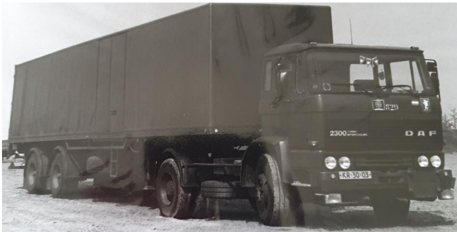
DAF FT 2305 DHU 325 trekker voor 23 tons oplegger 100 kN 4 x 2 1981 Als gebruikt door 829 Zwctie.
