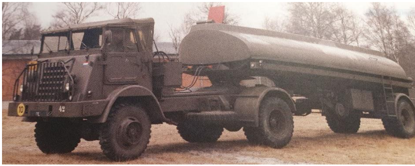
DAF YT 514 trekker 5 ton 4 x 4 (1960) DAF YAF 1034 benzine tankoplegger 10.000 liter (1960) Foto: 1985
