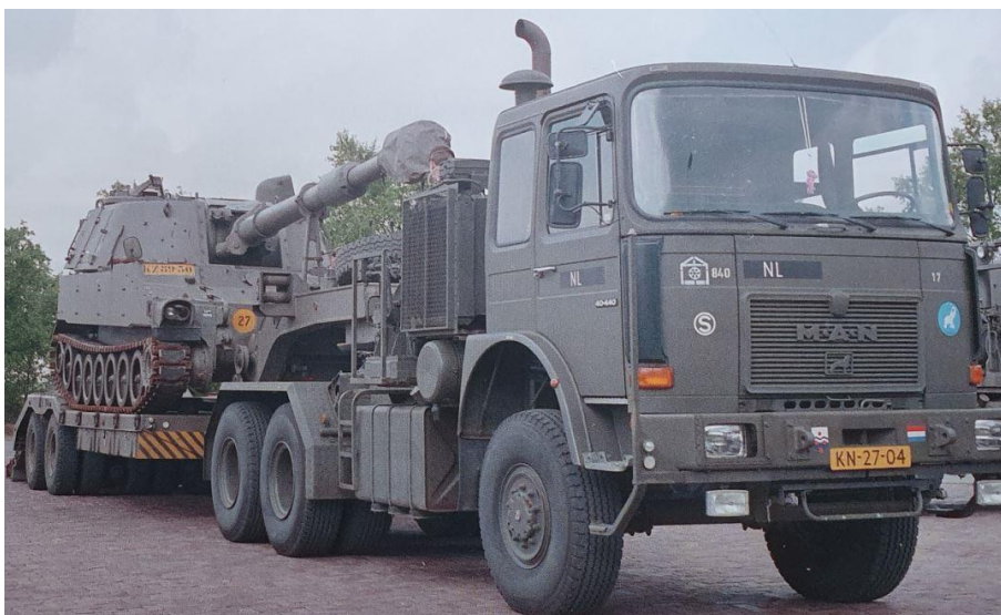
MAN 40.440 DFS trekker, 29 ton 6 x 6 1985 met oplegger DAF YTS 610050 50 ton - 8 wielen 1966
