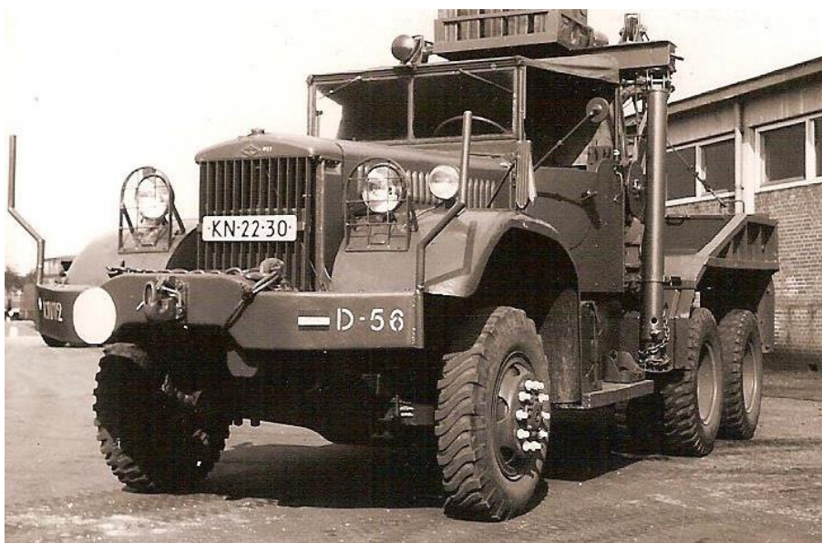
Het "vlaggenschip" van de D-Cie van 112 Tbat te Nunspeet, de Diamont T 969 takelauto, 4 ton, 6x6, 1951 – jaren 60
