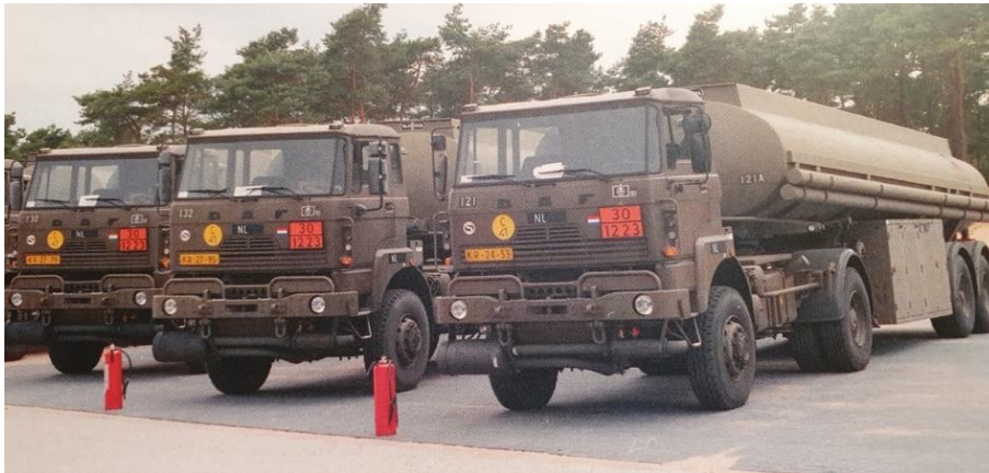
DAF YTV 2300 DHS 10 ton 4 x 4 (1981) Trekker Met van Hool brandstofoplegger 21.500 liter (1986) foto 1987
