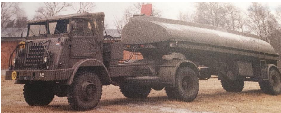
DAF F YT 514 trekker 5 ton 4 x 4 Met DAF YAF 1034 benzine tankoplegger 10.000 liter 1985
