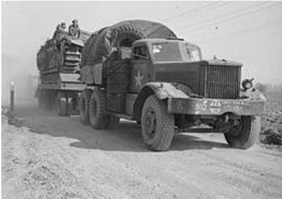
Diamond T M-20 Ballast tractor 4 ton 6 x 6 met 5 tons Rogers aanhanger In gebruik tot 1964
