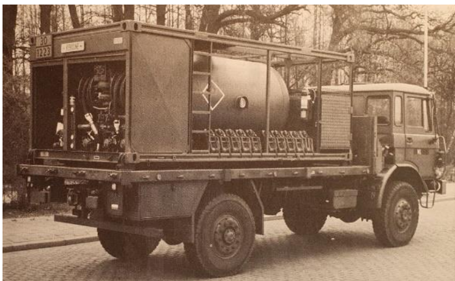
DAF YF 4442 DNT Brandstoftankauto met pomp, 40 kN, 4 X 4, 1992
