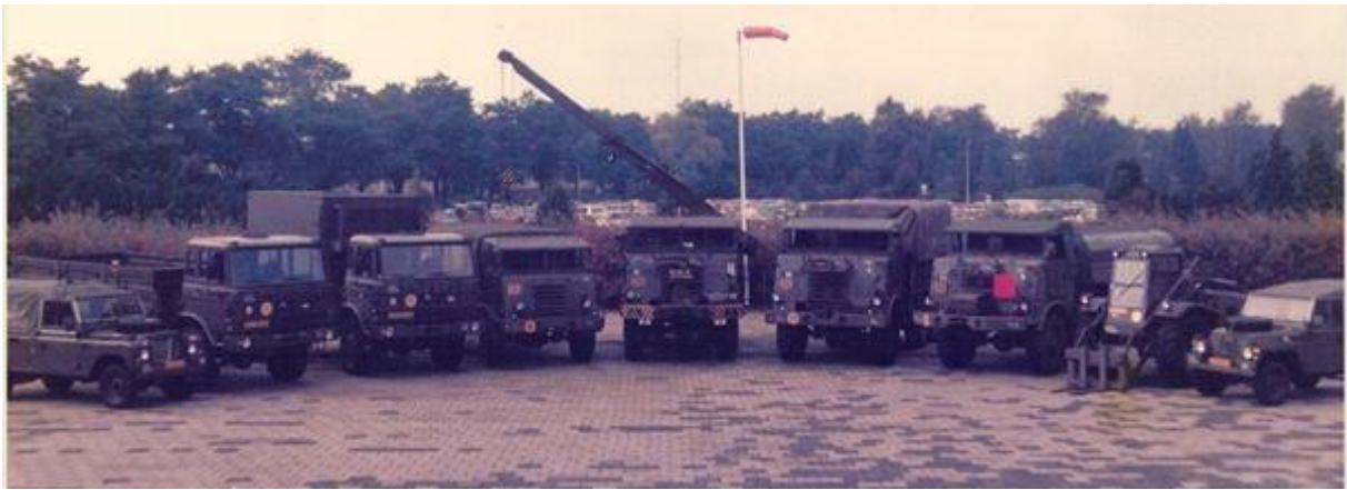
Voertuigen als in gebruik bij 13 Bevocie, Lpl Nunspeet, 1982: v.l.n.r.: Landrover 0,75 kN (OHgroep en stafpel), DAF YA 4440 (jerrycan vervoer), DAF YAS 4440, (shelteropbouw/container), DAF YA 314 (oud/oefendoeleinden), DAF YB 616 Bergingsvtg (OHgroep), DAF YA 616 (gemengd tpel), DAF YF 616 (tanker gemengd tpel), Volvo BM TOR (vorkheftruck munitie), Landrover 0,5 kN.
